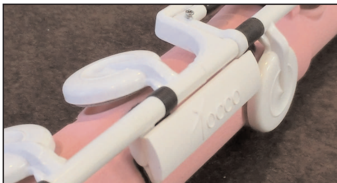
Fig. 4 - Particolari della rinnovata meccanica della serie "Tocco", che introduce ingegnose soluzioni tecniche.
